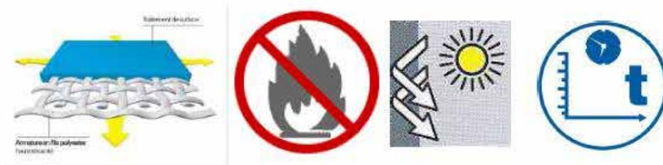
**Hilo:** Multifilamento 100% poliéster (con mayor resistencia que la poliamida), hilos antihumedad hidrófugos y con filtro ultravioleta. Confección con doble aguja y doble pasada.
